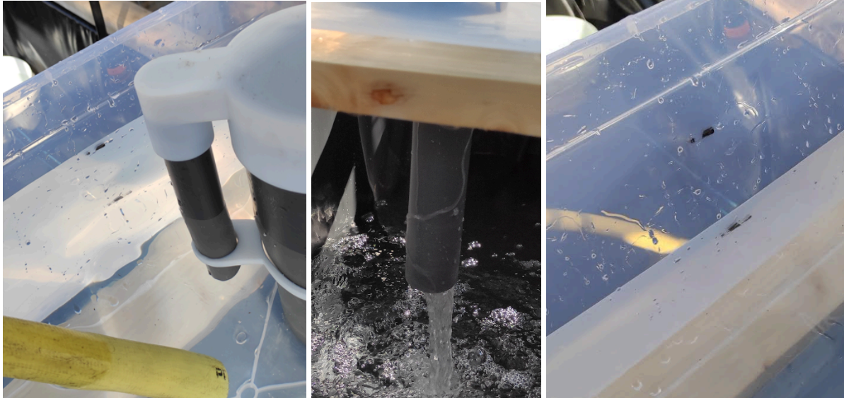
Figure 13 : Photographies de gauche à droite : remplissage jusqu'au niveau haut puis amorçage puis atteinte du niveau bas
