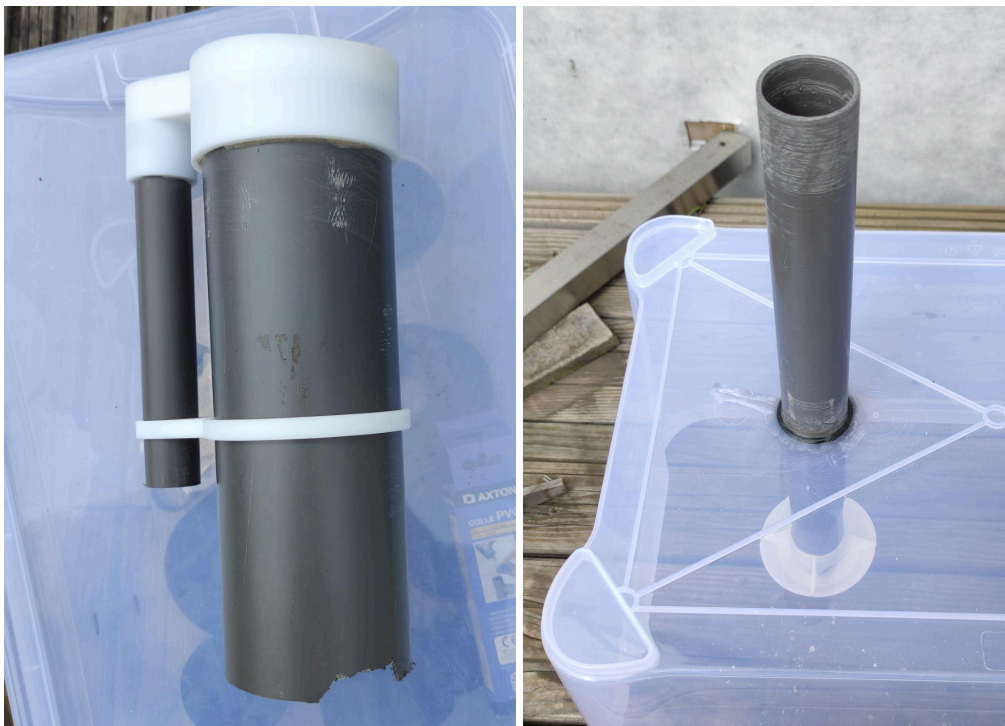
Figure 12 : Photo des deux parties du siphon en cloche avant assemblage
