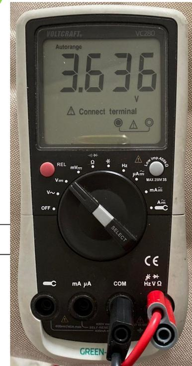
*Mesure de la tension de la capacité avec un multimètre*
