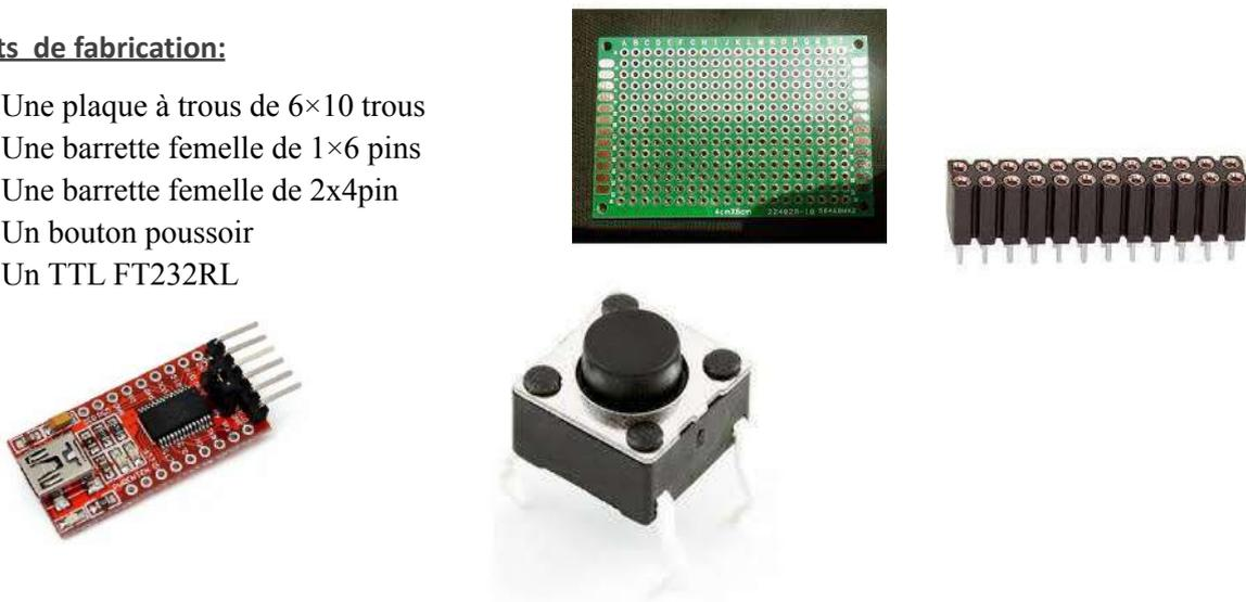
*Figure 1: photo des différents éléments*
