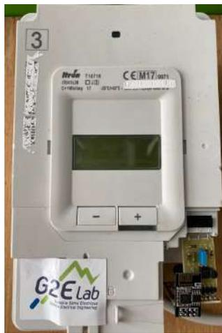
Figure 2 : Compteur Linky avec capteur Winky branché sur sa borne TIC
