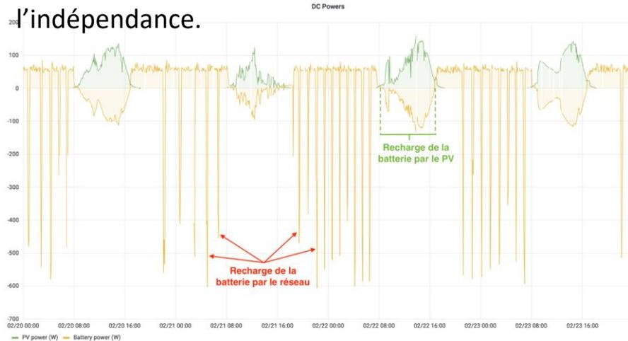
Figure 1 : Puissances des sources continues sur 3 jours avant ajustement de l'onduleur.
