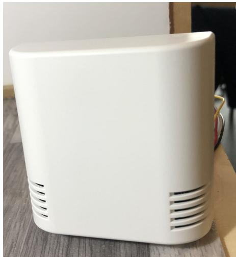
Nous avons installé trois capteurs différents (luminosité, température et humidité) au sein d'une boîte au premier étage du Tiny house. Le câble jaune relié au capteur de température, le câble blanc à l'humidité et le câble vert à la luminosité.
