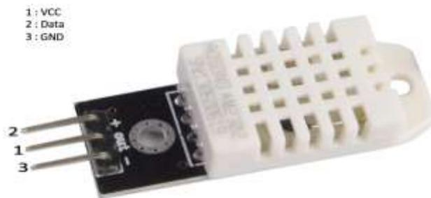
Nous allons récupérer les données de température et d'humidité à partir du capteur DHT22. Ce capteur va recueillir ces deux données simultanément, avec une précision de +/- 0.5°C pour la température, entre -40 et 125°C . Pour l'humidité, le capteur va donner une valeur entre 0% et 100% d'humidité, avec une précision de +/-5%.
